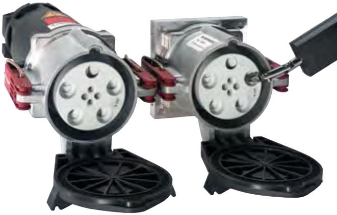
Die Steckvorrichtungen der schweren Baureihe erweitern die zurzeit genormten Steckvorrichtungen nach EN 60309-2 um Nennströme von 160 A bis 600 A sowie Nennspannungen bis 1000 V. Sie werden in Anlehnung an DIN EN IEC 60309-1 gebaut.
