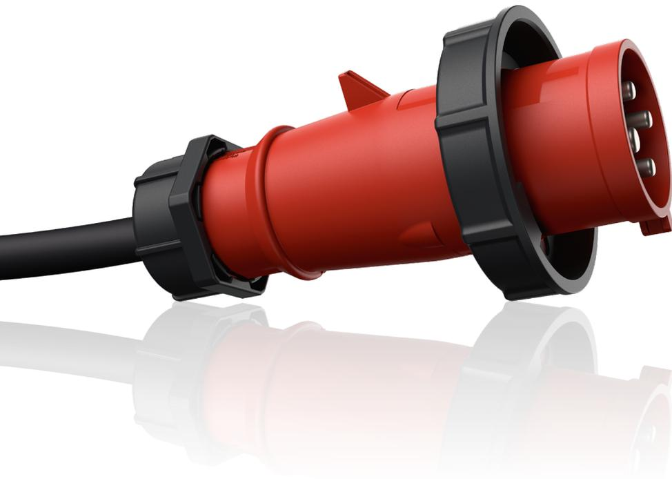
Der neue Containerstecker mit PE-Wender passt auf 4-Pin-Steckdosen, die auf 3 h oder 6 h ausgelegt sind (32 A, 400–440 V) und macht das ohnehin verbotene Abschneiden der Codiernase ab sofort überflüssig.
