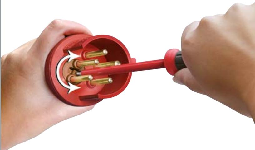
Wenn Drehstrom-Motoren im falschen Drehsinn laufen, löst der Phasenwender das Problem sicher und schnell. Mit einem Schraubendreher die Sperre lösen und das Isolierteil mit den zwei Phasenstiften drehen. Fertig – der Motor läuft richtig. Zwei Außenleiter um 180° drehbar.
