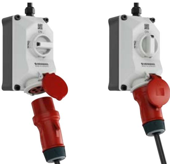
In OFF-Stellung ist der Schalter verriegelt. Der Stecker kann nur gesteckt und gezogen werden, wenn der Schalter in OFF-Stellung steht. Der Schalter kann erst in ON-Stellung gedreht werden, wenn ein Stecker in der Steckdose ist.
