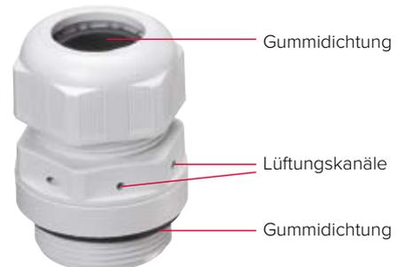
Durch Lüftungskanäle kann die innen vorhandene Luftfeuchtigkeit entweichen. Die im Inneren der Kanäle angebrachte Membrane verhindert das Eindringen von Außenfeuchtigkeit. Schutzart IP67 bleibt erhalten.
