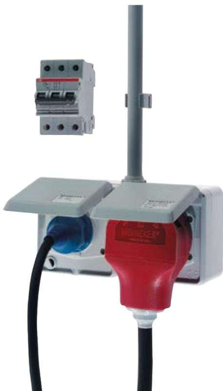
Eine häufig gewählte Steckdosenkombination: 16 A CEE und SCHUKO® 16 A. Bei Anschluss dieser Kombination über eine Zuleitung ist ein 3-poliger Automat obligatorisch.
