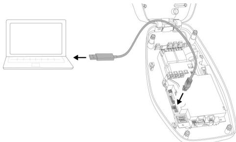
Abb. 1: Verbindung einrichten (Beispiel: AMTRON® 4You 100 / 300)
