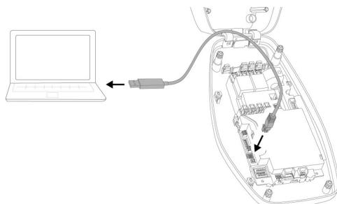
Obr. 1: Vytvoření připojení (příklad: AMTRON® 4You 100 / 300)
