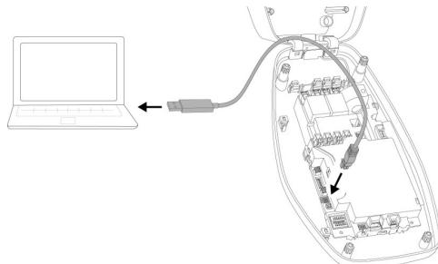
Kuva 1: Yhteyden laatiminen (esimerkki: AMTRON® 4You 100 / 300)
