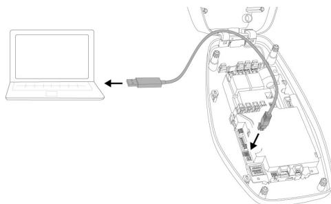
Fig. 1 : configuration de la connexion (exemple : AMTRON® 4You 100 / 300)
