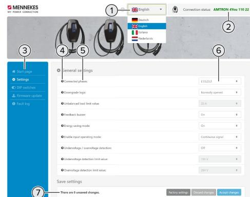
Fig. 2: Konfigurationsverktygets uppbyggnad (exempel)
