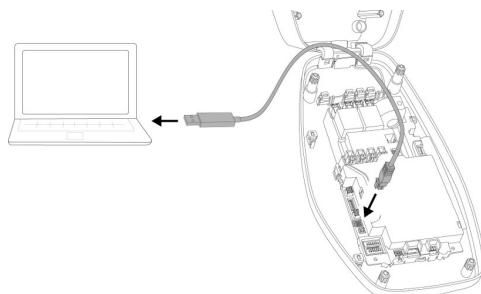
Fig. 1: Etabler forbindelse (eksempel: AMTRON® 4You 100 / 300)
