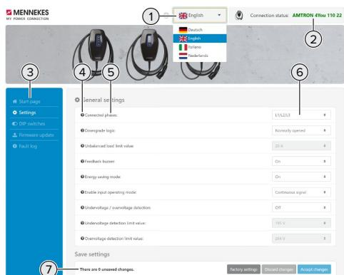
2. Ábra: A konfigurációs eszköz felépítése (példa)
