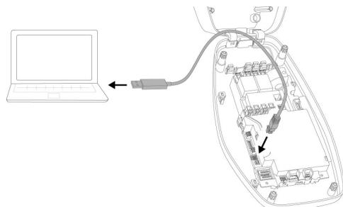
Εικ. 1: Ρύθμιση σύνδεσης (παράδειγμα: AMTRON® 4You 100 / 300)
